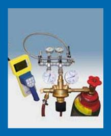
Injection d'un gaz non toxique dans la conduite, mélange 95% azote / 5% hydrogène.
